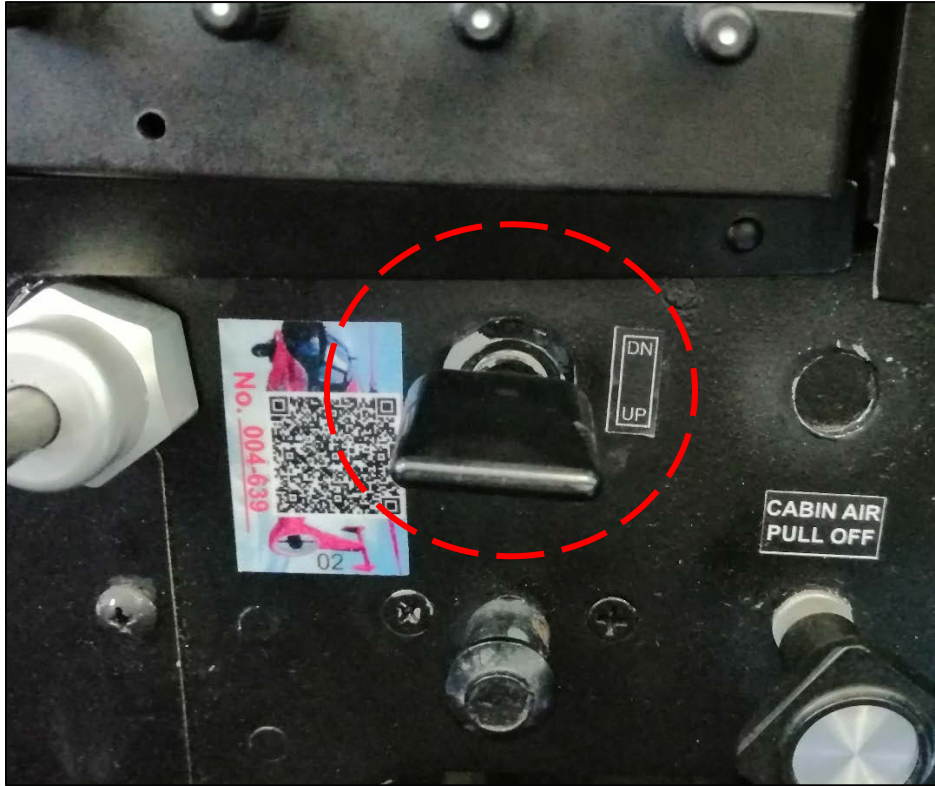
Fotografía No. 5: Placa mal puesto en la selectora de flaps HK5100G.
